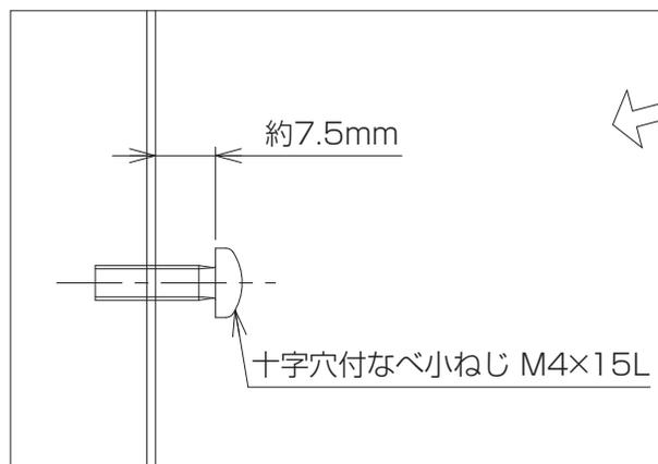
OAタップを本体へ仮固定する為、上図の通り、ボルトを本体の取付穴にねじ込みます。
