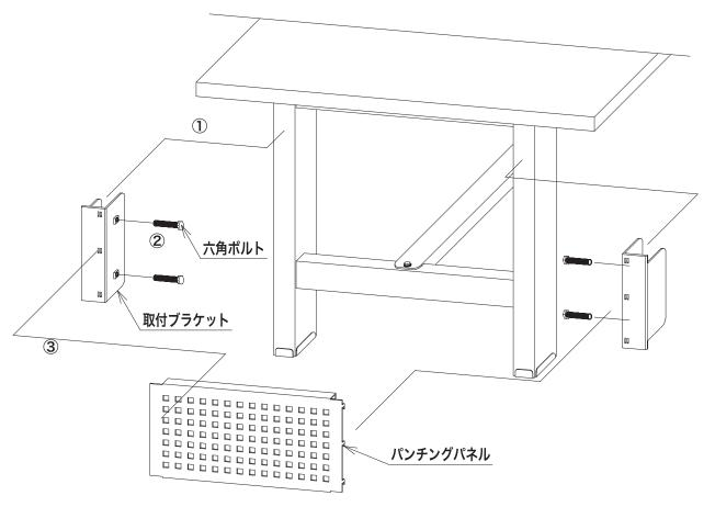
手順 1 取付ブラケットを作業台の 脚フレームに差込みます。
