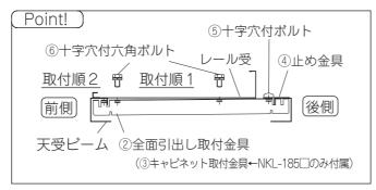
キャビネットを引いて、レール受の穴位置と先程セットした全面引出し取付金具②キャビネット取付金具③の穴位置が重なるように調整してください。
