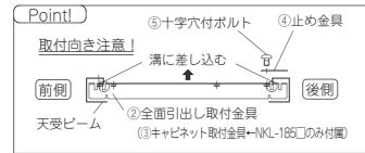
裏返した作業台に全面引出し取付金具②を左図の様に セットし止め金具④と十字穴付ボルト⑤で仮止めして 下さい。
