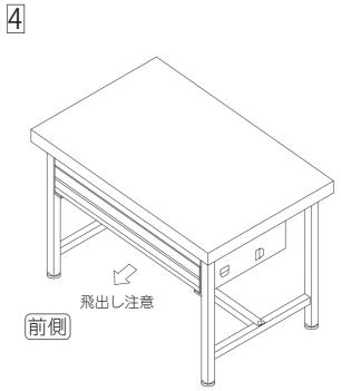
全面引出しの取付位置を調整後、全てのボルトを本締めしてください。最後に本体を起こせば完成です。
