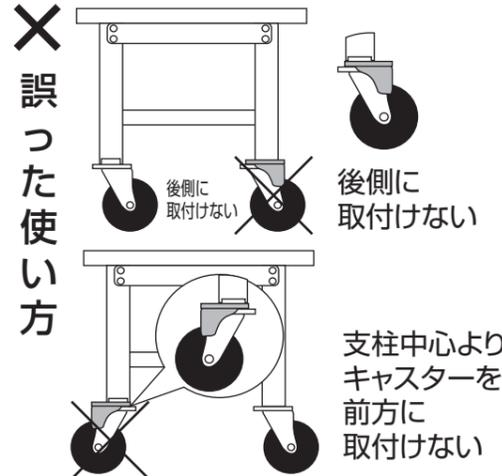
①脚フレームにキャスターを取付ける際、図1のように、直進安定金具、スプリングワッシャ、キャスター(ストッパー無)の順に脚フレーム支柱に取付け、板スパナで締めます。(向きに注意)
