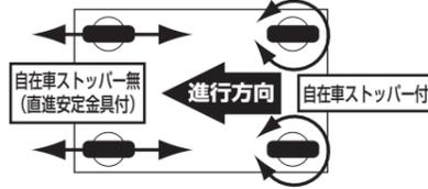
②必ず脚フレーム中心よりキャスター中心が後方へくるよう取付けて下さい。
