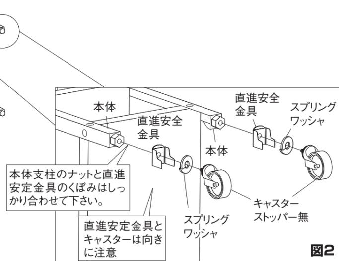
**注意** 直進安定金具は必ず正しい取付け方を守って下さい。(表面参照)
