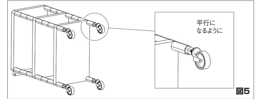
④仮組み状態でキャスターの位置を進行方向と水平になるよう支柱を回転させ方向を決めて下さい。
