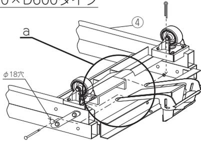
1. ペダルピン⑮を本体左側面のφ18穴から通して下さい。
