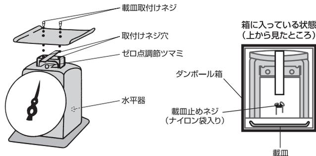
※載皿はしっかり取付けてください。載皿がグラツクと計量物が落ちたりしてケガをする場合があります。
