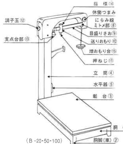
(2)運送中の部品の脱落、破損の有無をよく点検してください。
