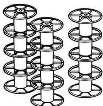
※枠から外した回転ドラムは2個以上、シャフト部凹凸の結合により芯ズレのない積み重ねができます。
