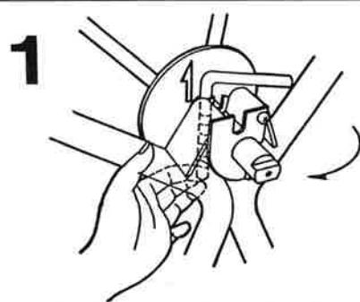
空転防止バー(スプリング付)を下から指で押し上げ、90° 外側に回転させる。
