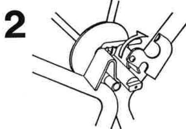
ロック金具(枠の外側のドラム飛び出し防止用)を時計方向に回転させる。
