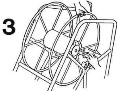
ドラムを持ち上げ、着脱シャフトを引抜く。(ドラムを取り付ける時は3→2→1の順に操作する。)
