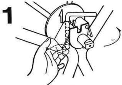
空転防止バー(スプリング付)を下から指で押し上げ、90° 内側に回転させる。
