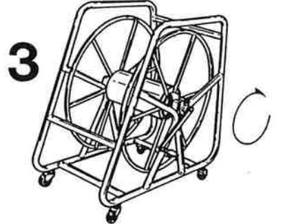
ドラムを回転させる。(ハンドルを着脱させないときはM6のビスで着脱シャフトとハンドルを固定させててもよい。)
