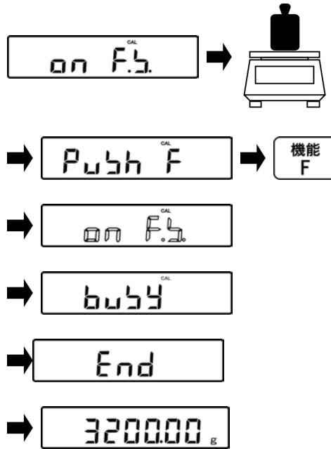
ゼロ点の調整が終了し、表示が「on F. S.」になったら、分銅を計量皿の中心に載せます。
