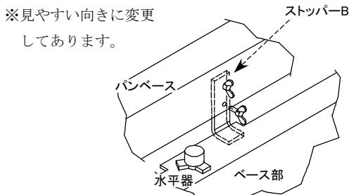
①ストッパーBをパンベースの外側から取り付け、ストッパーの先端をベース部の内側に潜らせます。
