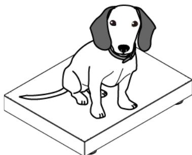
重量の変動が設定した範囲内に収まると値をホールドします。表示がホールドされると、表示部に「**H**」が表示されます。
