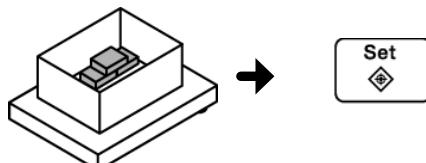
計量物を降ろします。「\*」マークが表示されたら、[Set] キーを押します。
