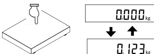
計量部を軽く押し、表示が変化することを確認します。
