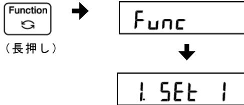
[Function] キーを長押しします。表示が「Func」に変わったらキーを離します。
