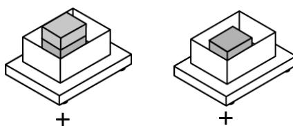
次の計量物を載せます。加算累計選択時は、[Tare] キーを押して風袋引き後、計量物を降ろします。「\*」マークが表示したら [Set] キーを押します。
