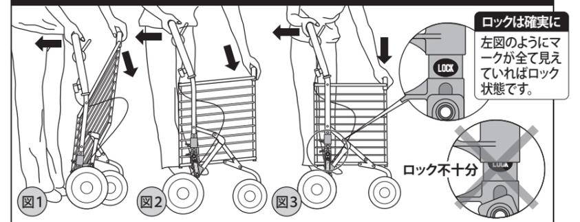
組立は開閉グリップを斜め下方向に押さえ、ハンドルを水平方向に引いてください。LOCKマークが全て見えているとロック(図4)された状態です。ロックが不完全な場合は、再度ハンドルを引いてください。折りたたむ時は両サイドの組立ロックレバーを解除するとたためます。
