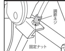
ブレーキがあまくなった時は固定ナットをゆるめ調節ネジを左方向に回して調節した後、固定ナットを締め付けてください。
