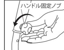
ハンドル固定ノブを左方向に回転させ、ハンドルを適当な高さに合わせて、ネジを強く締め付けてください。
