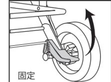
ストッパーを掛ける時は、矢印の方向にフットレバーを上げ、ストッパー棒が車輪内側の溝にはまるようにしてください。この時左右の車輪溝にストッパーがはまっているか確認してください。
