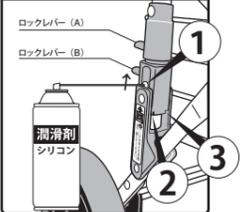
ロックレバー(B)を左図に示す↑方向に上げ、矢印1、2、3の所に注油してください。ロックレバーが上らない時は、矢印2、3に注油ロックレバー(B)を上げ矢印1に注油してください。※注油剤はシリコンが最も適しています。かけ過ぎないように注意してください。
