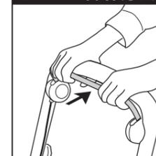
①ハンドルブレーキを手前に引くとブレーキが掛かります。②ブレーキを掛けた状態にするときは、ブレーキロックスイッチを②上図のように下げハンドルブレーキを引いてください。解除するときは上げると(②下図)通常の状態に戻ります。
