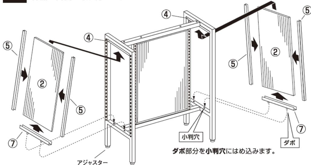
最後に全てのネジが固定されているかご確認ください。アジャスターを調整して水平を保ち、安全にご使用ください。
