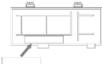
5. 赤いワイヤをバッテリーの+端子に接続し、黒いワイヤをバッテリーの-端子に接続します。バッテリーをバッテリー室に入れます。
