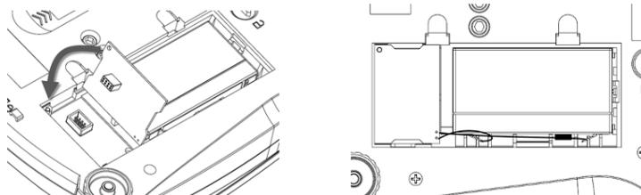
7. 上図のように、バッテリーを配置し、ワイヤを配線します。
