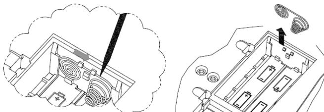
4. 下図のように、バッテリーカバーの内側に警告ラベルを取り付けます。
