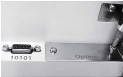
Option と記載されたフェイスプレートを固定している 2 本のネジをドライバーで外し、このプレートを取り除きます。ネジは、新しい RS232 インターフェイスボードを取り付けるときに使用するため、保管しておきます。
