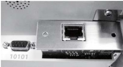
新しいイーサネットインターフェイスボードをディスプレイに差し込みます。デバイスがスロットに正しく固定されるよう注意してください。
