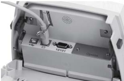
必要に応じて、ディスプレイ通信ケーブルを外します。通信ケーブルを外すと、作業しやすくなります。
