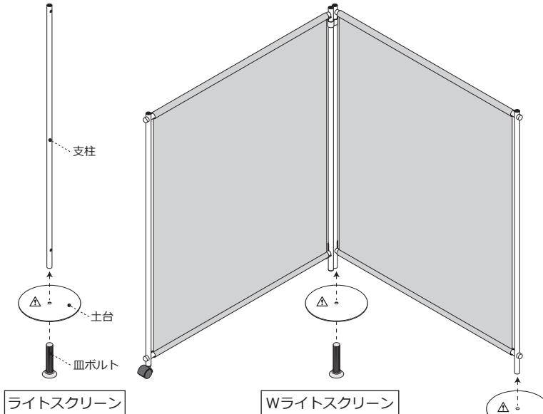
②下図のように生地の両端に丸パイプを通し、支柱と丸パイプを組み立ててください。
