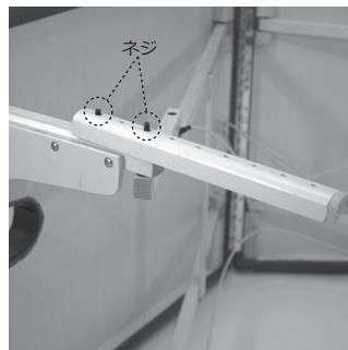
③ご希望の高さに外脚を調節し、外脚の穴(2カ所)に内脚のネジを差し込んでください。
