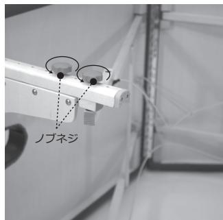
①ノブネジ(2カ所)を反時計回りに回し、ノブネジを外します。
