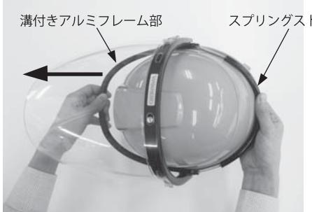
①片手でスプリングストッパー部をヘルメットの淵に合わせて固定し、もう一方の手で溝付きアルミフレーム部をヘルメットのツバ先まで引っ張ります。
