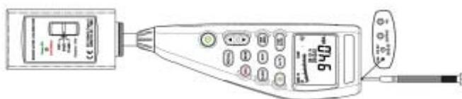
校正するためには、校正器にマイクを入れてネジを閉めます。騒音計の電源をいれて、時間の動特性を“Fast”にして、周波数特性を“A”にします。校正器の電源を入れて、中間(94 dB)に合わせます。表示値が異なる場合は、同梱のドライバーで調整してください。
