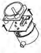
**!** 新しいセンサから短絡ブリッジ/補助回路板を取り外すのは、取り付け直前にしてください。短絡ブリッジ/補助回路板を取り外した状態でセンサを15分以上放置しないでください。
