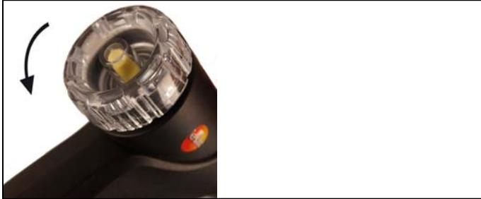
1. 排ガス・プローブのフィルタ・チャンバーを反時計回りに回して、開きます。
