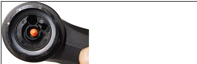
4. ガス流路にシーリング・プラグを挿入して、流路を閉じます。
