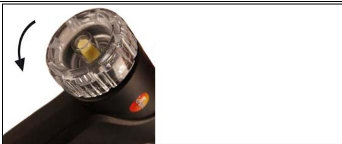
1. フィルタ・チャンバーを反時計方向に回して、取り外します。
