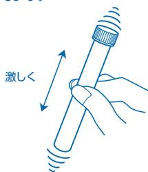
⑤ チューブ壁面全体にR-2試薬が行き渡るように、キャップをして②と同様にチューブを上下に激しく振り混ぜます。
