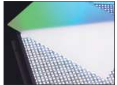
薄型面発光透過型の内部写真。 発光面の真下にチップLEDを実装しています。
