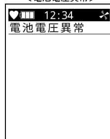
<電池電圧異常>
