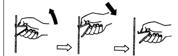
棚網は必ず棚柱と棚受けの爪の間に
