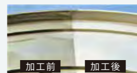
治具付着膜を表面を粗さずに除去
