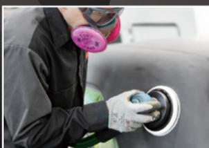
広面積の色はぎ・足付け作業も、3M™ キュービトロン™ II 研磨材製品をはじめ、さまざまな形状・粒度の研磨材でサポート。迅速で均質な仕上がりを実現します。
