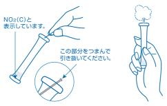
①チューブ先端のライン を引き抜きます。 ②穴を上にして、指で チューブの下半分を 強くつまみ、中の空気 を追い出します。
