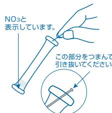
①チューブ先端のラインを引き抜きます。
