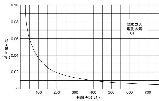
上記の図は、塩化水素の濃度に対する吸収缶の有効時間を示したものです。作業環境のガス濃度に応じた有効時間を破過曲線図で算定し、使用時間が算定有効時間になった場合は新しい吸収缶に交換してください。有効時間はガスの種類、温度、湿度によっても差が生じます。
