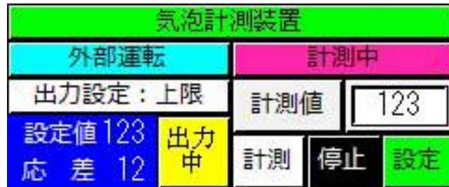
基本画面（外部運転出力中）
