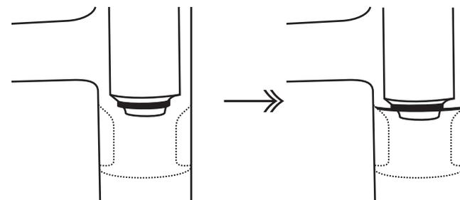
③ テフロンプラグの長さを調整した後ガラステーパ部に先端 O リングが達すると上図のようにガラス壁面に密着し密栓されます。
