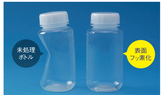
キシレン注入30日後の変形写真
