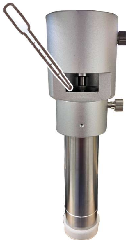
④ スポイトなどの器具を用いて、保護フレームの窓からサンプルをチューブに注入します。
