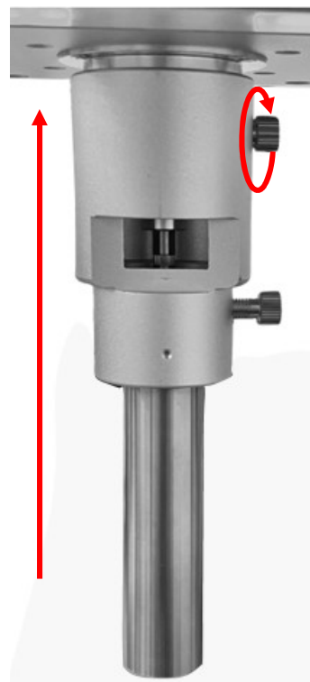
② No.0スピンドル用保護フレームをスピンドルの下側から上に通し、上側のつまみネジで固定します。
