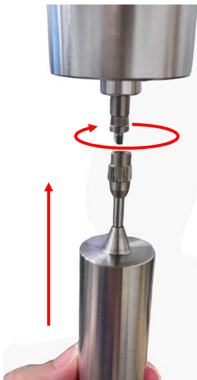
① No.0スピンドルをスピンドル接続部に回して取り付けます。
