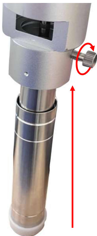
③ 筒の下端（線が1本ある側）にプラスチック製キャップを取り付け、スピンドルをチューブ内に挿入するようにして奥まで差し込み、No.0スピンドル用保護フレームの下側のつまみネジでチューブを固定します。
