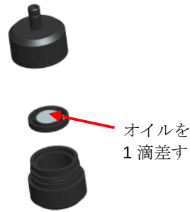
Figure 4-3: インパクタープレートへのオイル差し
