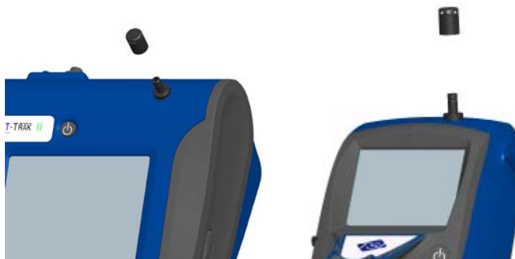
図 2-3: インレットノズルキャップの差し込み
