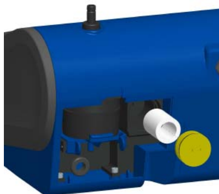
図 4-5: フィルタの取り外し(テストトップ)
