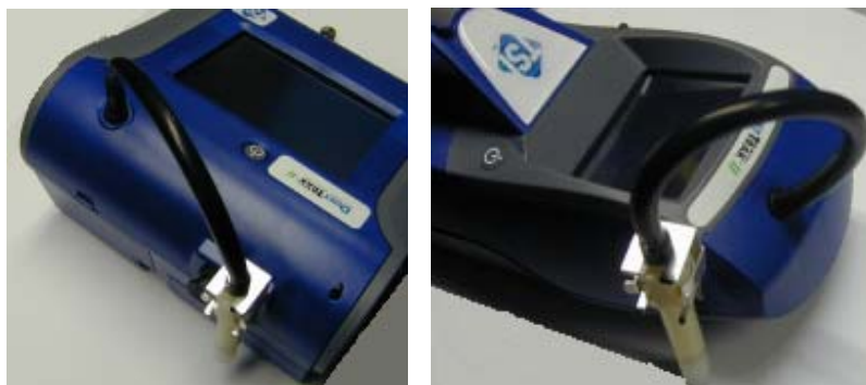
図 2-5: Door-Oliver サイクロンの装着
