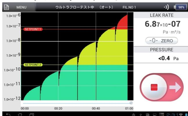
スタンバイ状態で、試験体等をテストポートに接続します。▶をスライドすると、粗引きを開始し、規定の圧力に達すると測定を開始します。■をスライドすると、測定を終了します。
