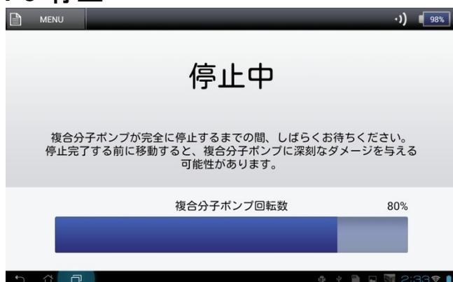
[MENU]-[停止]を押し、確認画面で YES を押すと、複合分子ポンプの回転数を示す停止画面が表示されます。およそ 1 分程度で停止動作が完了すると初期画面に切り替わります。初期画面に切り替わるまでは、本機を移動したり、振動・衝撃を加えることはしないでください。
