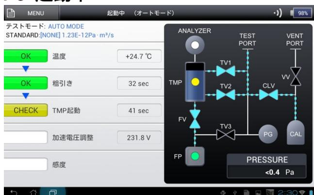
機器に異常が無いことを確認するために、機器内部温度確認→排気系(粗引き)→排気系(TMP)→分析系の調整→感度校正→起動完了となります。起動完了後、テスト画面に切り替わります。詳細は、{7}を参照ください。
