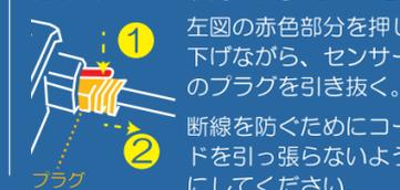
左図の赤色部分を押し下げながら、センサーのプラグを引き抜く。
