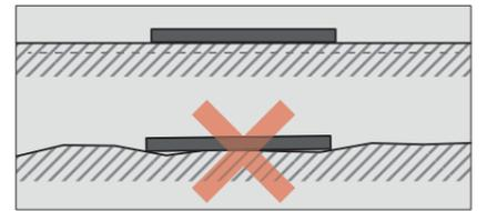
※1 検査対象の異物管理暴露モニター板は必ず水平面に置いてください。凹凸面に置くとオートフォーカスが正確に作動しません。
