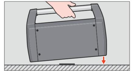
※2 本体と設置面に隙間ができるとLEDの光が漏れ、正確な検査ができません。
