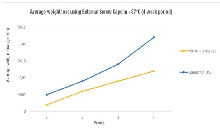
図3. +37℃でのアウターキャップの密閉性比較
