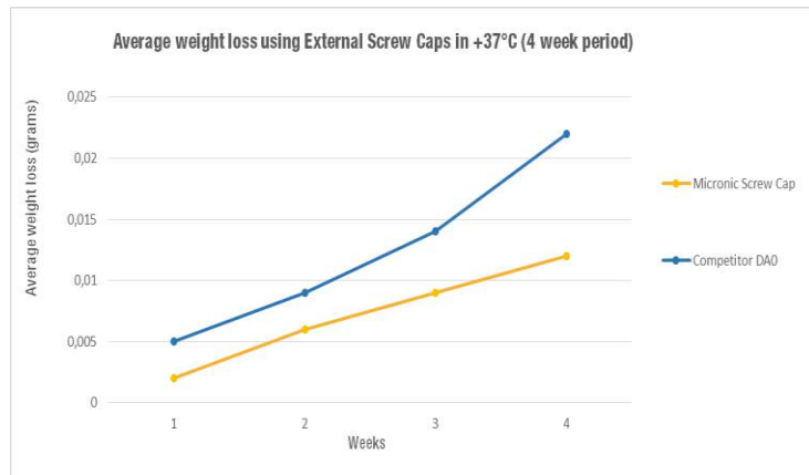
図3. +37℃でのアウターキャップの密閉性比較
