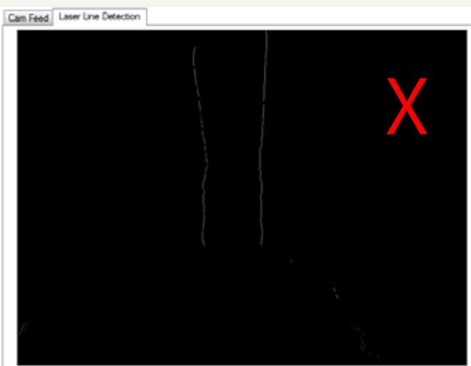
左のラインに破線が出始めています。ラインが崩壊し始めている事を示しています。
