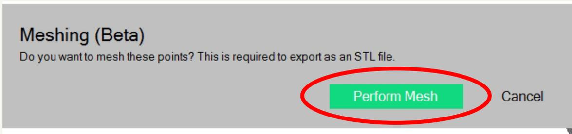
設定が完了したら「Perform Mesh」をクリックしてください。ファイルの生成が開始されます。生成が完了しましたら STLファイルの保存先を指定して名前を付けて保存してください。
