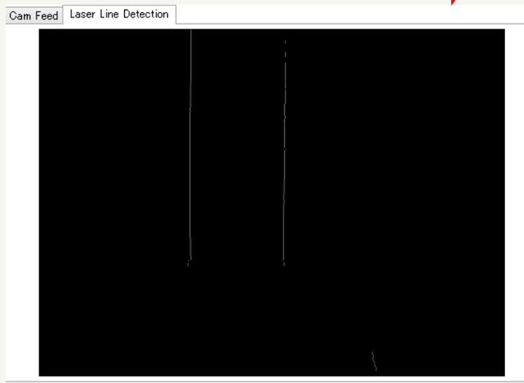
白いラインがオブジェクトの表面ディテールをレーザーが捕えた状態を確認します。線の状態がなるべく繋がった、破線や点線にならない、綺麗なラインが出る様に調整します。
