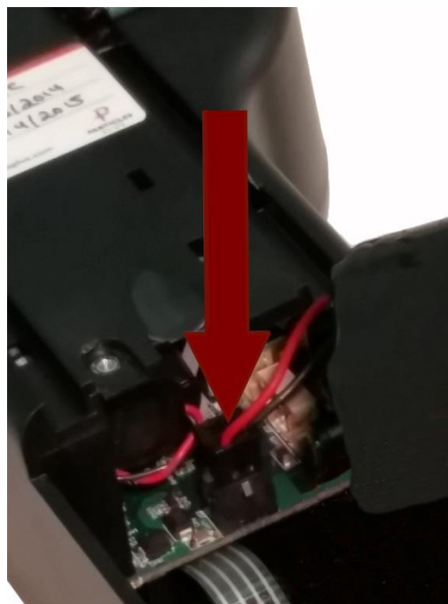
Step 4 – バッテリーコンパートメント内の PCB 基板上のソケットにバッテリーコネクタプラグを挿入します。NOTE: 赤と黒のリード線はコネクタの下端に配置します。
