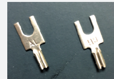
K型純正Y端子 (Y) 熱電対素材で作られた Y端子 (M4) の取付 M3用の端子台にセットできるよう 片側カット加工できます
