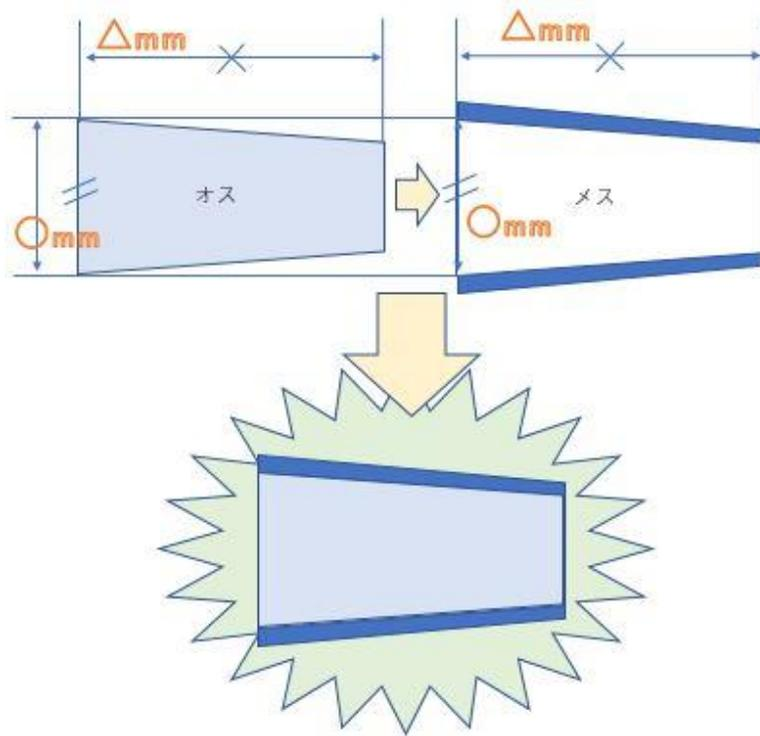
左側の数字 = 摺り合わせ部の大径φが一致していれば、摺り合わせ部の長さは一致しなくても接続は可能です。
