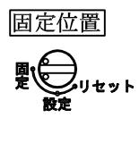
④裏面の設定スイッチを固定位置に戻し設定完了です。
