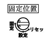
④裏面の設定スイッチを固定位置に回し設定完了です。
