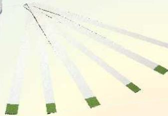
「残留塩素試験紙」ディッパーは次亜塩素酸カルシウム、次亜塩素酸ナトリウム、塩素ガスなどによる水中の残留塩素を測定する試験紙です。本試験は、色素・フルオレセイン・臭化ナトリウム、緩衝剤を濾紙に含浸したもので、塩素により色変化します。
