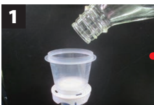
試料液をメンブランフィルターでろ過
