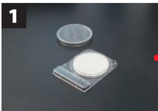
キャップをはずして一定時間静置
