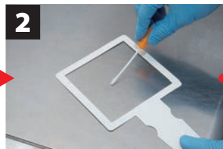
2 キャップをはずして綿棒を取り出し、ふき取る(ふき取り棒100使用)
