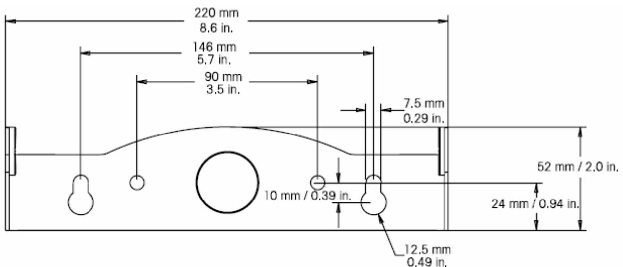
図 2-6 壁掛けブラケット寸法図
