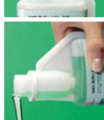
バッファ液ボトルを傾けて、使用したバッファ液を捨てます。使用後は、バッファ液ボトルのキャップをきちんと締めて保管してください。
