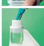
試験容器部分に直接pH計を入れ、校正・調整を行います。校正・調整の方法については、pH計の取扱説明書の指示に従ってください。
