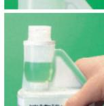
ボトルを手で押して、校正・調整に必要な量のバッファ液を上の試験容器部分に押し出します。
