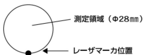
測定距離が280mmのとき、レーザーマーカは測定領域の下の位置を指します。測定の目安としてください。
