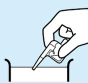
測定する油を、目安線まで吸い上げ、中の発色剤と10秒間よく振り混ぜます。その後、1分間放置します。
